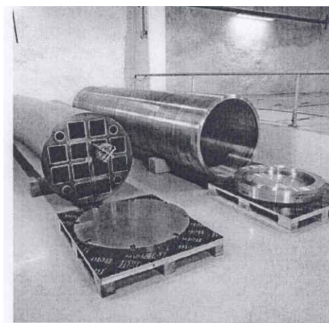
Рисунок А-7.В.3. Опытный контейнер (вмещает 12 ТВС реактора ВВР АЭС «Олкилуото»)
